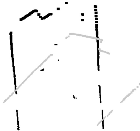
FIG. 3.2 – Deux scans. En recalant le jeu gris sur le jeu noir on aura une estimation du déplacement qu'il y a eu entre les deux scans.
