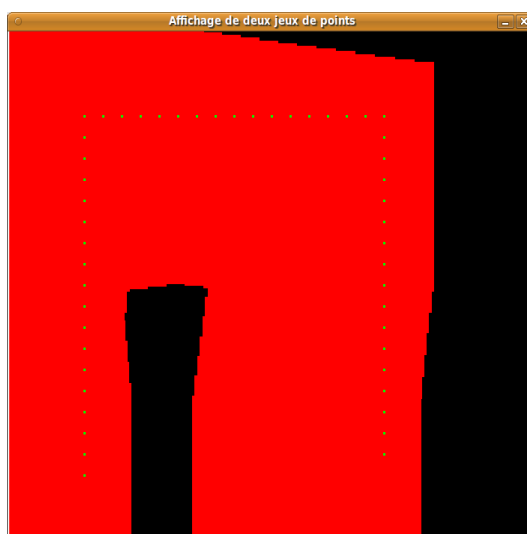
FIG. 4.3 – Le jeu model est toujours en vert, en rouge on peut voir la transformation du jeu scene par [T_0] , avec [t_{x_0}] = [-100, 100] , [t_{y_0}] = [-100, 100] et [r_{z_0}] = [5^\circ, 20^\circ] .
